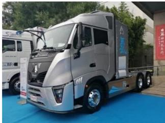
搭载氢发动机的黄河牵引车
