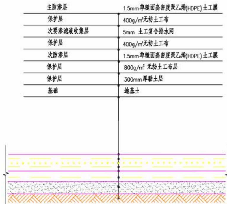
图 8.3-9 渗滤液调节池防渗系统大样图
