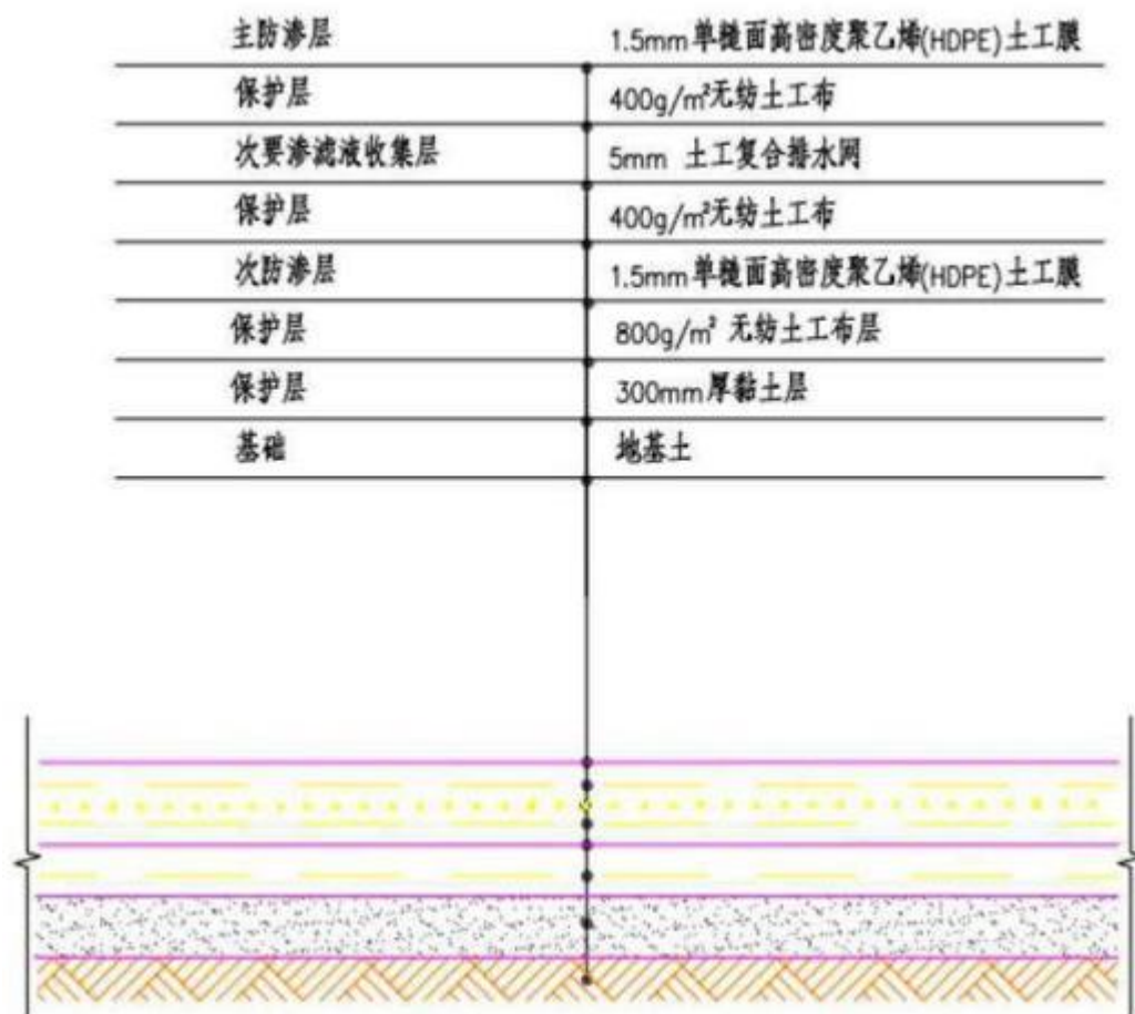
图3.4-3 渗滤液调节池防渗系统大样图
