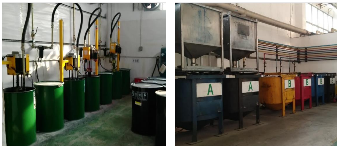
图 8-1 某印刷企业中央供墨系统
