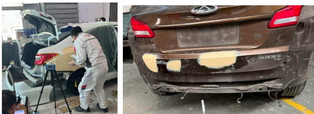
图 3-13 腻子涂抹及干燥过程废气基本未收集处理
