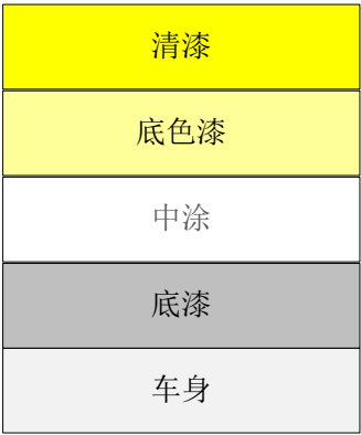
图 5-1 汽车涂层顺序
