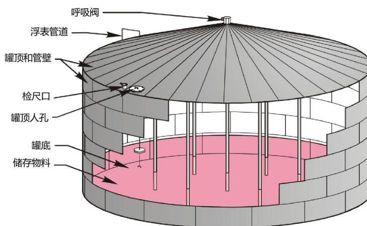
图 5 固定顶罐常见附件标识示意图
