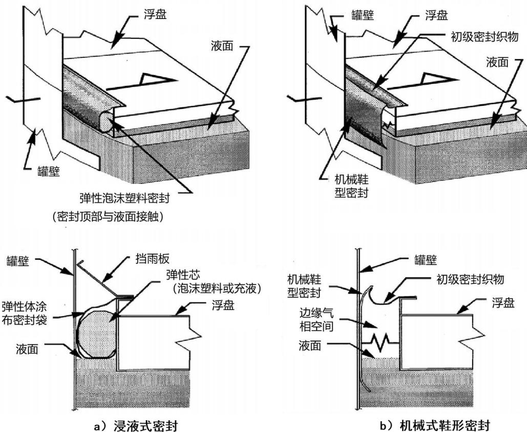
图 3 常见浮顶罐高效密封方式示意图
