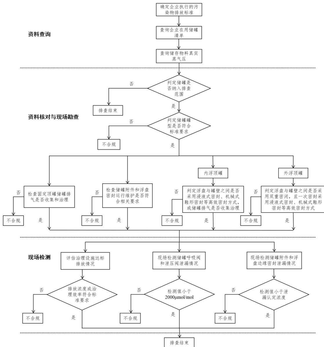
图 1 挥发性有机液体储罐排查流程
