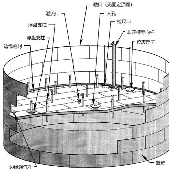
图 7 外浮顶罐常见附件标识示意图
