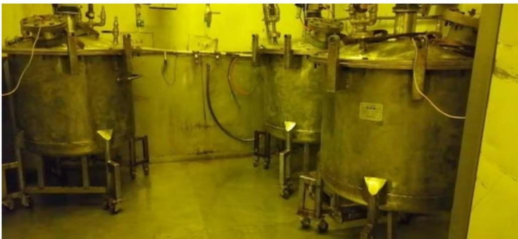
图 2.7-1 涂布胶料管道输送、密闭混料
