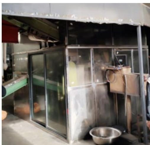
图 2.3-9 压延高温加热辊轴工段收集情况
