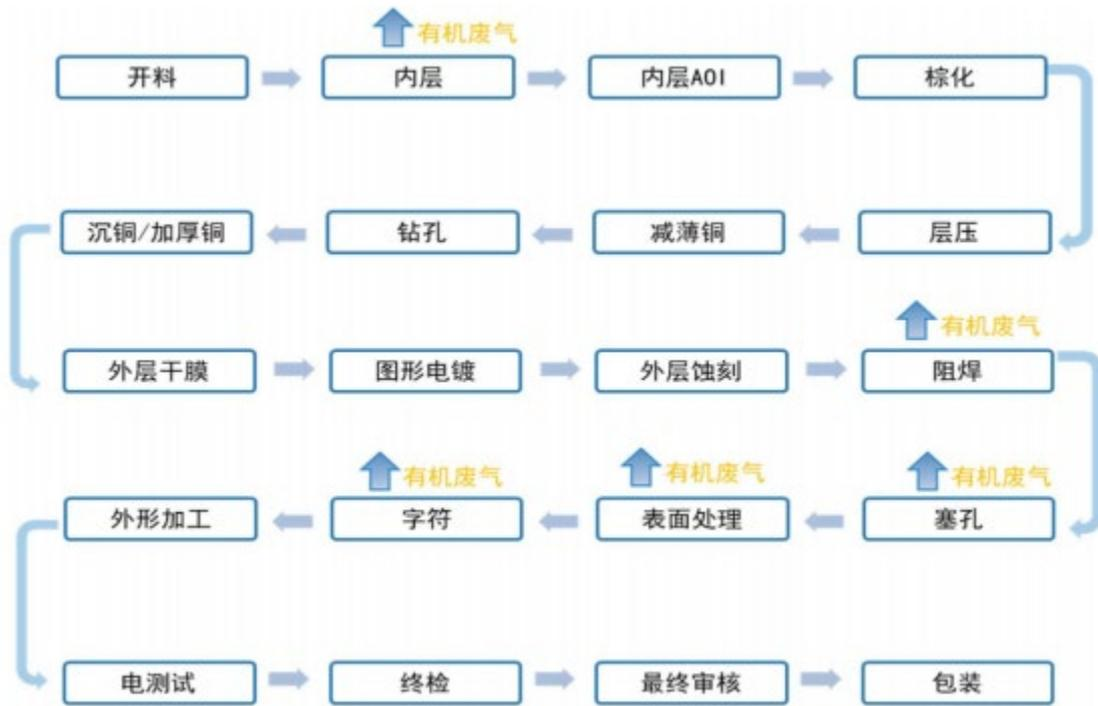
图 2.1-6 生产工艺流程及 VOCs 产污环节
