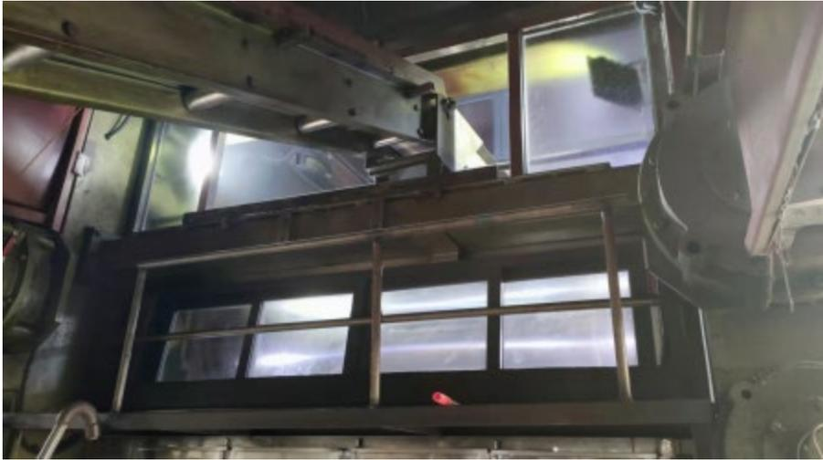
图 2.3-10 工段产污工位精细化围闭收集
