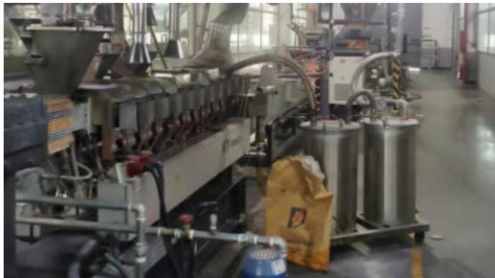
图 2.3-7 双螺杆挤出机末端真空泵连接及油污暂存罐
