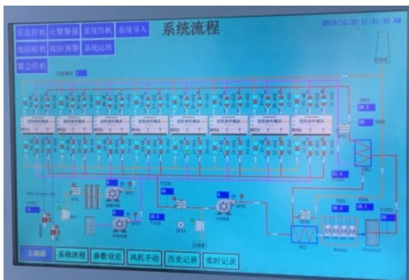
图 3.5-2 活性炭纤维吸附+催化燃烧处理系统中控监控系统
