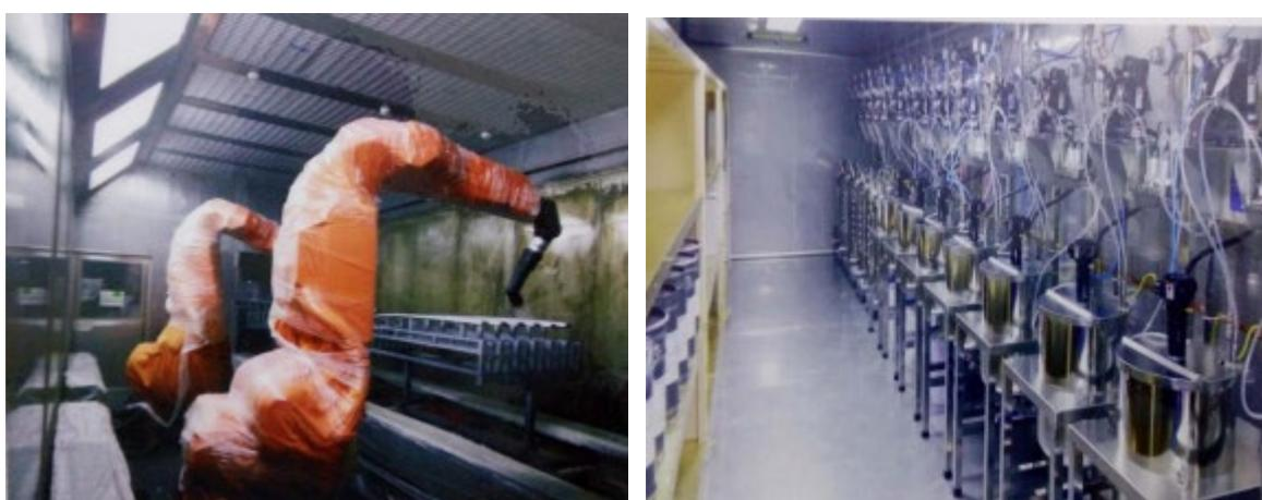
图 2.3-4 密闭生产车间和自动喷漆设备
