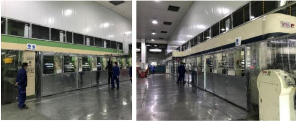
图 3.5-1 印刷生产线密闭情况
