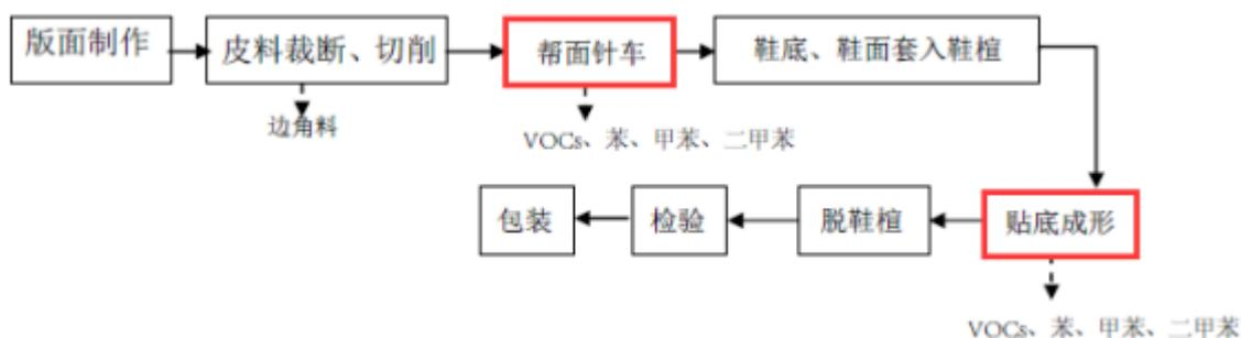
图 2.4-1 制鞋总工艺流程图
