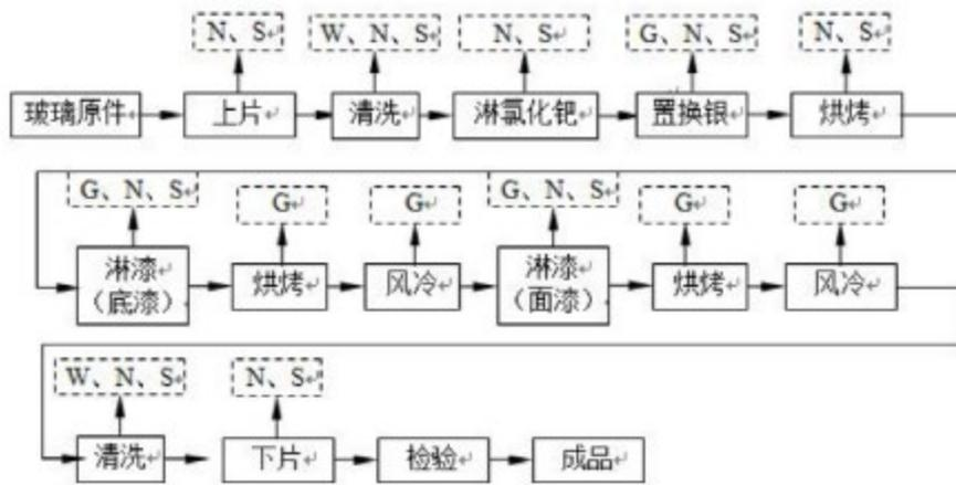
图 3.6-1 镜板加工生产工艺流程图
