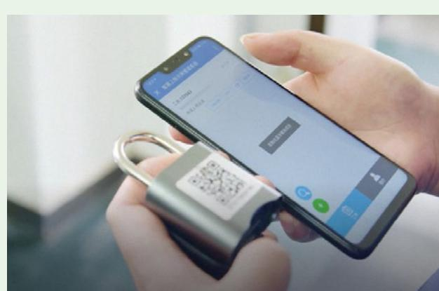
智能系统LOTO利用手机应用程序控制具有定位功能的蓝牙锁管理许可和流程。
