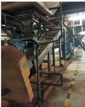
窑灰、尾气除尘收集无轴螺旋机
