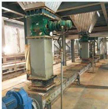
窑灰、尾气除尘收集无轴螺旋机
